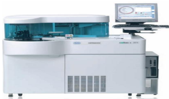
الشكل (١) الجهاز المستخدم لقياس مستوى اللاكتات في الدم الوريدي (Cobas c 311)
